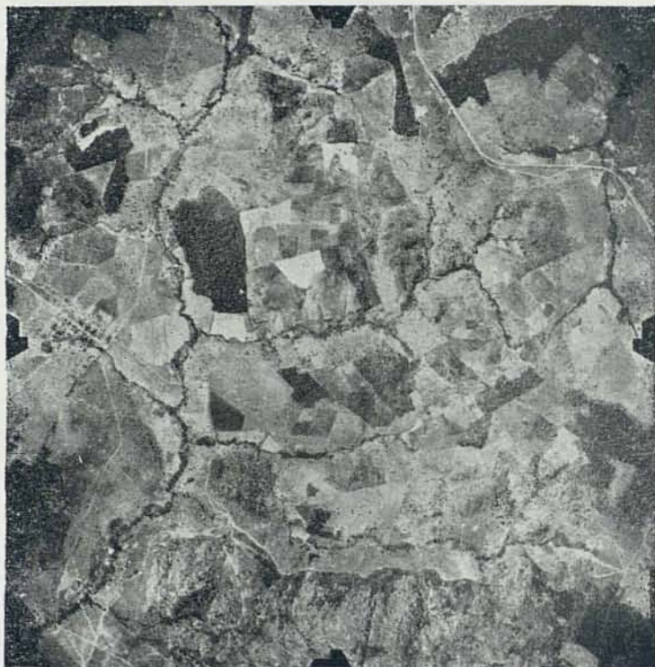
Figura II — Uma vista aérea mostrando uma área de típico gnaisse tal como é encontrado nas vizinhanças de Nerópolis. Nesta área, o gnaisse foi despojado do material da chapada e a rocha pode ser reconhecida por suas formas de drenagem características, pelo manto de solo e pela forma dos morros. A aparência desta disposição deve ser comparada com a do xisto na fotografia n.º III
