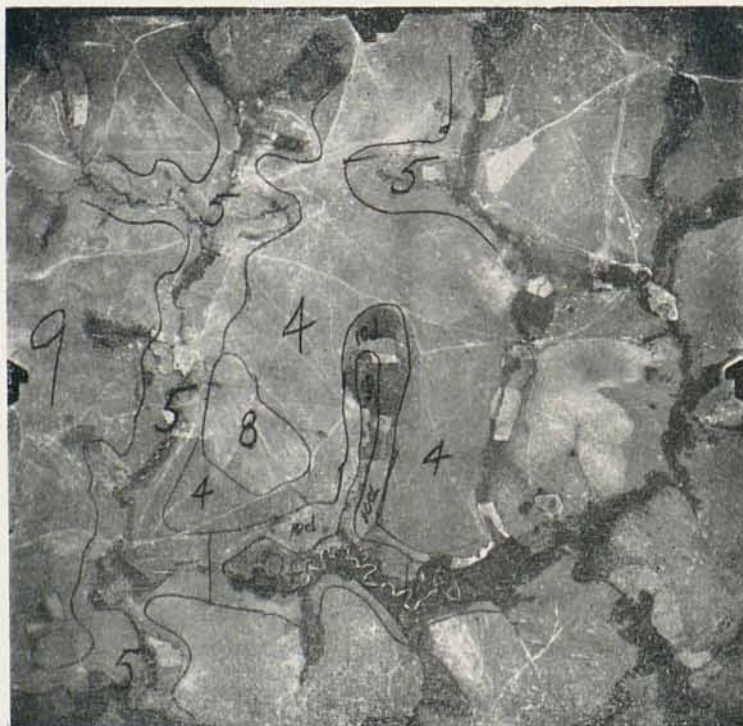
Figura 12 — Esta foto realça a relação da categoria 8 com as categorias 4, 9 e 10. As estrias que podem ser observadas na categoria 8 são devidas ao controle da superfície exercido pela rocha estratificada ou laminada
