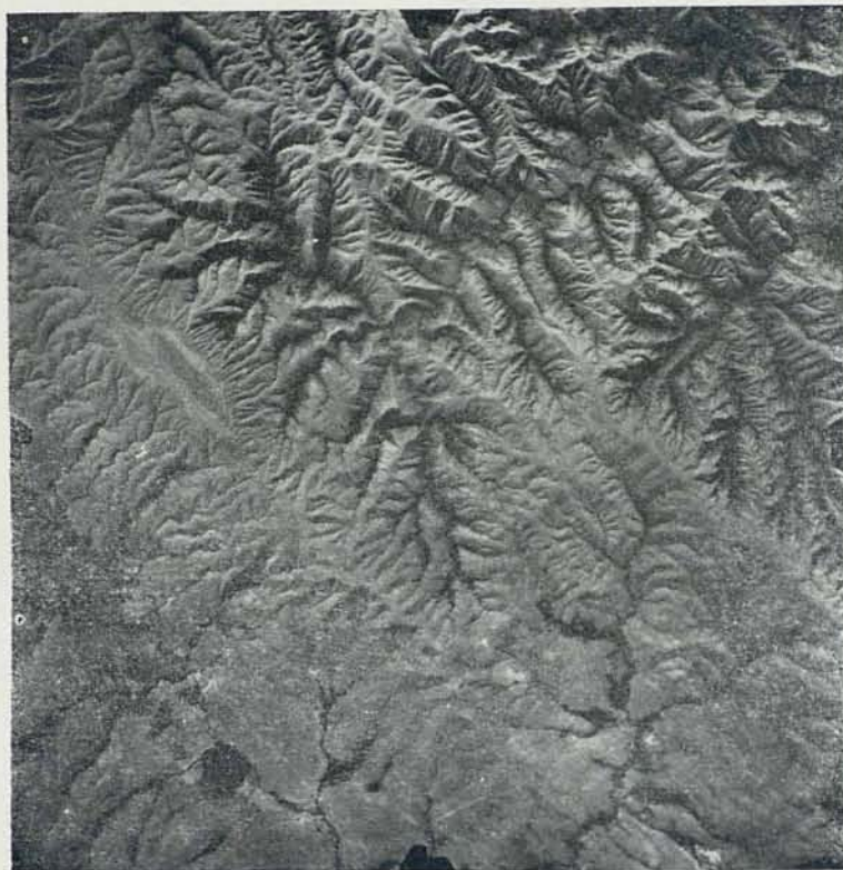
Figura XII — A rocha siltica não tem valor prático algum como material. É facilmente reconhecida por seu sistema de drenagem intrincado e pela forma de suas grotas. Sua facilidade de erodir-se e encher os vales de tremendas quantidades de silte torna-o objeto de séria consideração na localização de reservatórios adequados. É importante proteger estas áreas com cobertura florestal, se possível, a fim de que os rios e vales não venham a ser obstruídos pela silte erodida
