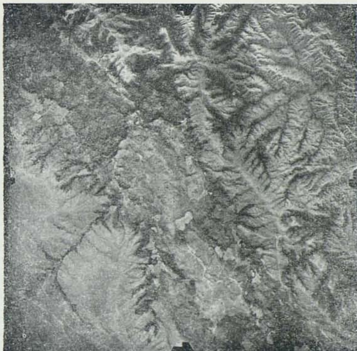
Figura VII — Os calcários do Retângulo são caracterizados pelos mesmos aspectos encontrados no mundo inteiro. Esta fotografia de uma área no canto sudeste do Retângulo ilustra a mudança de aparência que é experimentada quando o calcário é encontrado adjacente a outros tipos de rocha. Quando observado, estereoscópicamente, verifica-se que a área possui uma topografia cárstica típica completa, com dolinas, montanhas cônicas abruptas e falta de drenagem superficial. Tais áreas podem conter depósitos de bauxita ou matérias-primas essenciais para a manufatura de cimento portland. É, certamente, uma fonte de cal agrícola tão necessária para o tratamento dos solos do Retângulo
