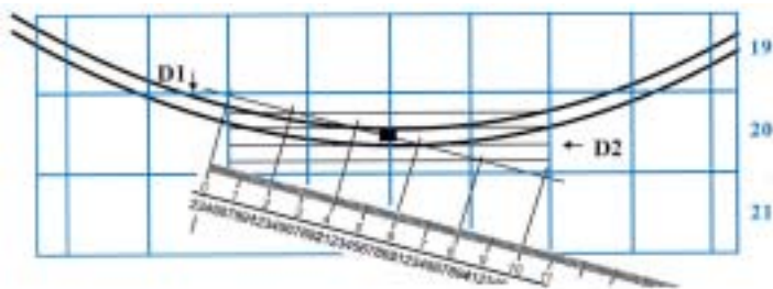
A – Como dividir o módulo 20 em cinco partes iguais.
